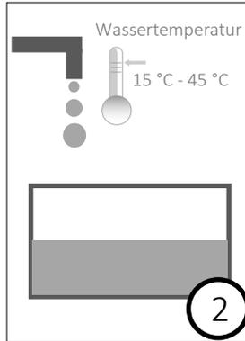
Vor Verwendung die Desinfektionswanne mit z.B. Actoclean® Flüssig und klarem Wasser\* gründlich reinigen, um Rückstände anderer, insbesondere aldehydhaltiger, Chemikalien zu entfernen. Die Instrumentenwanne anschließend mit Wasser (Zimmertemperatur) füllen.
